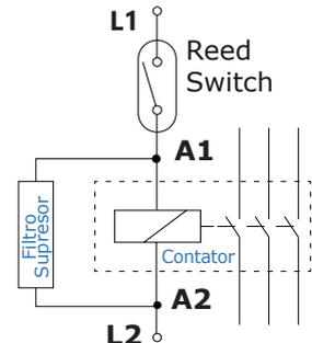
sensor de nível | chave de nível | boia de nível | chave boia | chave magnética de nível | controle de nível
